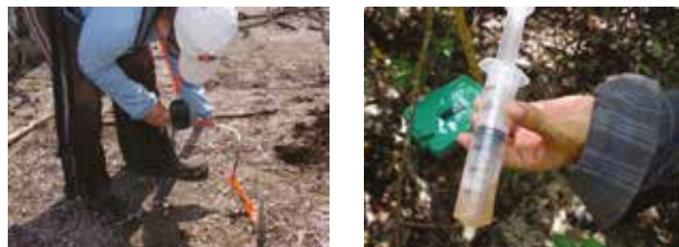
Figura 15. Obtención de agua intersticial, para el monitoreo de los parámetros fisicoquímicos.
