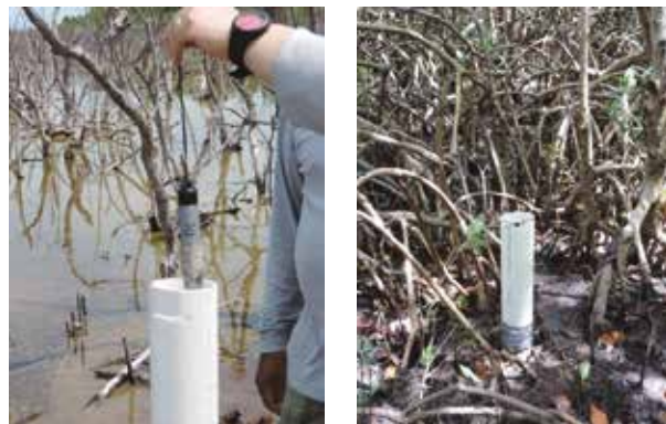
Figura 14. Fotografías de los sensores de presión utilizados para monitoreo del hidroperíodo.
