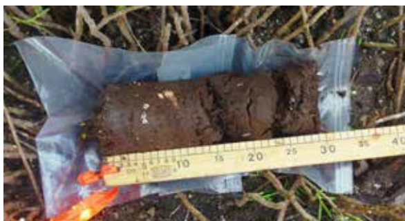
Figura 17. Monitoreo de características del suelo: Obtención de núcleo de sedimento para su posterior análisis.
